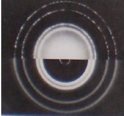
Slika 5. Difrakcija X-zraka (gornja polovica) i difrakcija elektrona (donja polovica) na aluminijumskoj foliji.
