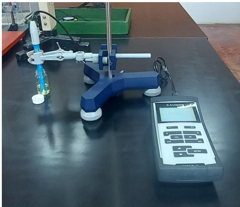
Slika 30. pH-metar HandiLab 100 , SI Analytics (XYLEM Analytics, Njemačka).
