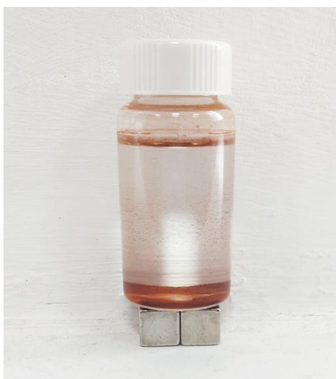
Slika 33. Uzorak nakon magnetskog razdvajanja s neodimijskim magnetom.
