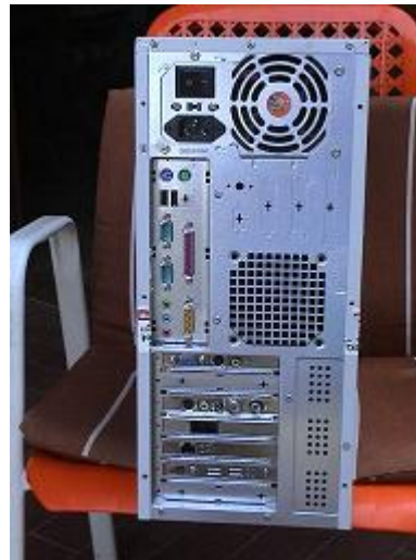
Slika 3. Stražnje strana PC-a (ventilator, priključci za naprave)
