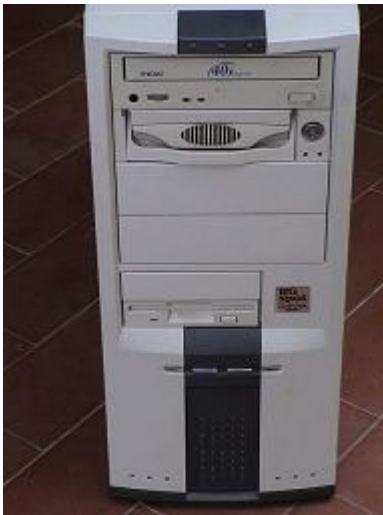
Slika 2. Prednja strana PC-a (uključivanje, disk, CD-ROM)
