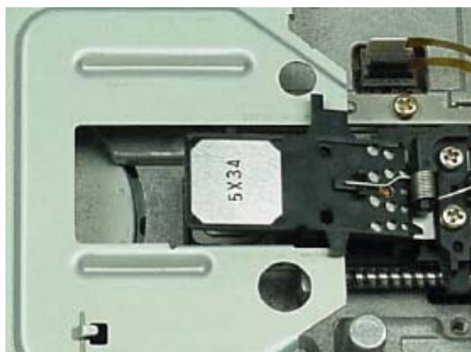
Slika 30. Magnetske glave u floppy napravi
